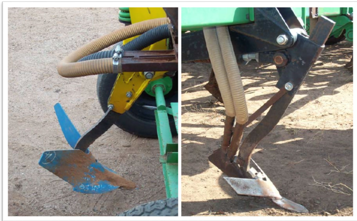
شکل ۵: گاوآهن های پمجه ای برای تولید پشته و کلوخه در خاک با بافت متوسط
