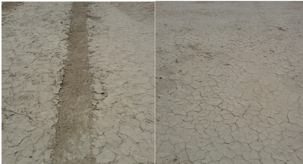
شکل ۱- تشکیل پوسته سطحی (الف) در خاک های مناطق مورد مطالعه، و تخریب پوسته ها در اثر تردد وسایل نقلیه (ب)
