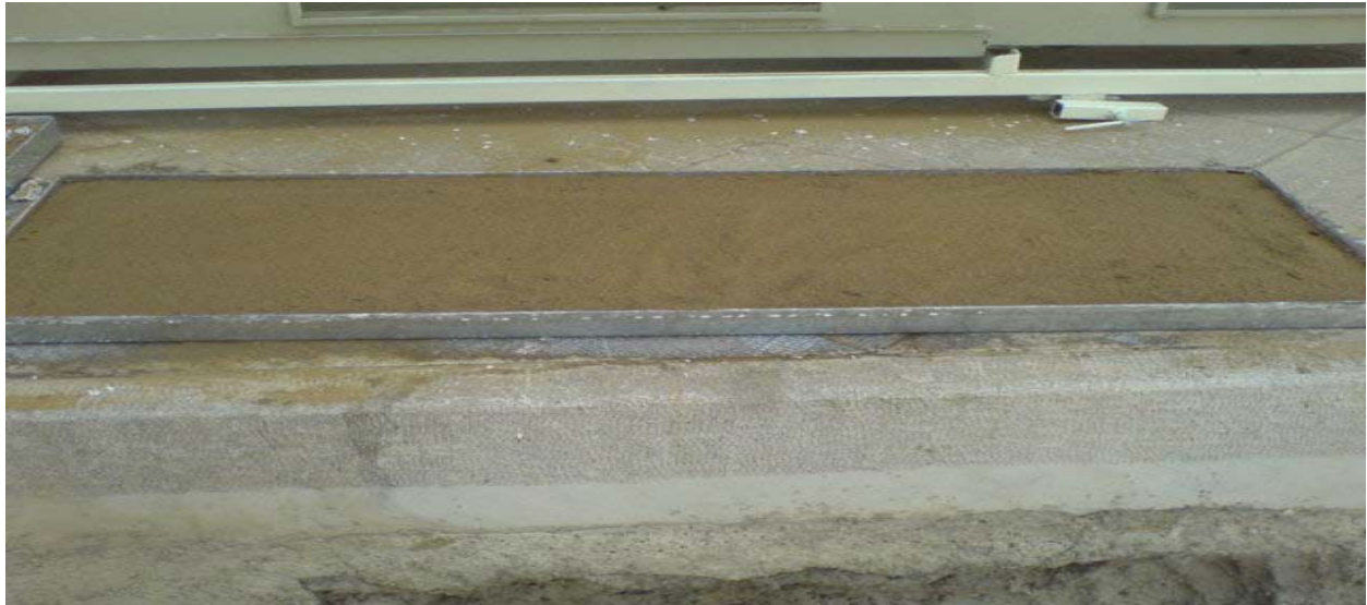
شکل ۳- تصویری از نحوه پخش شن در سینی دستگاه تونل بادی مستقر در مرکز تحقیقات اصفهان
